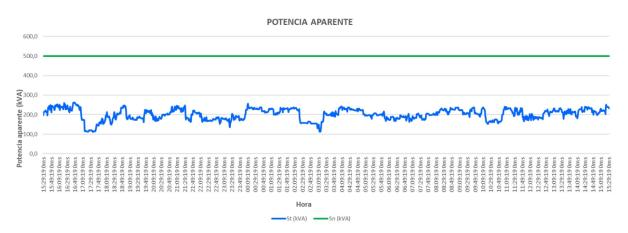
El valor de potencia aparente promedio durante el período de operación normal fue de 201 kVA, registrando un valor máximo de 262 kVA. En el ciclo completo de operación se registró una potencia aparente mínima de 112 kVA. La capacidad máxima del transformador es de 500 kVA.
