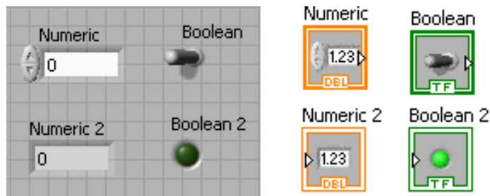
Imagen 14 Ejemplo de Controles vistos en panel frontal y Diagrama de Bloques LabView [22].
