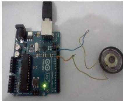
**Figura 134. Tocando tonos con Arduino**
