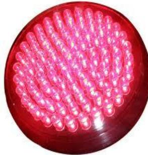
**Figura 115. Luz de leds rojos<sup>93</sup>**
