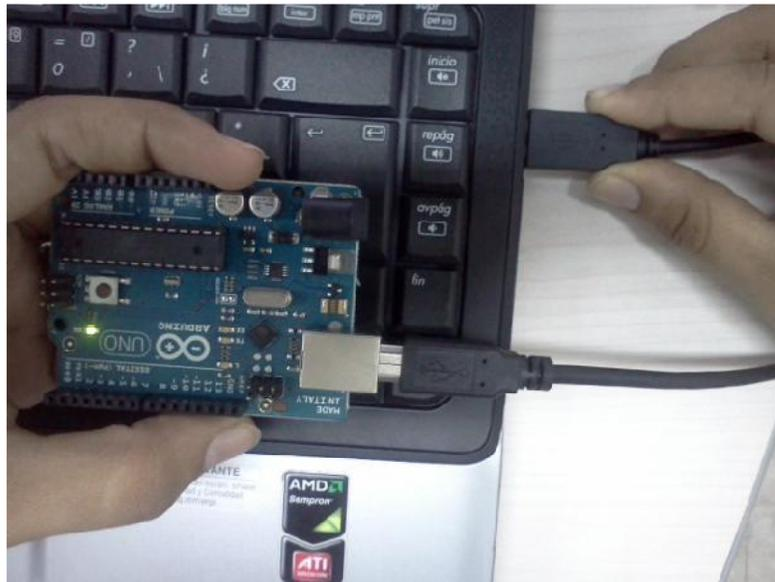
**Figura 87. Alimentación de la placa Arduino**
