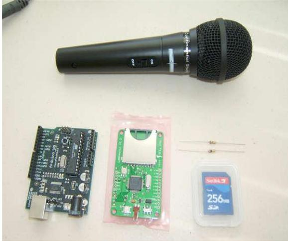
Figura 6. Materiales para realizar el micrófono<sup>17</sup>
