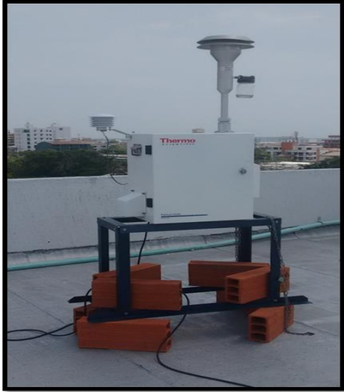
Figura 6.4 Equipo de muestreo de bajo volumen Partisol Plus 2025. (Rugeles Ahumada & Silva Tibabija, 2017).
