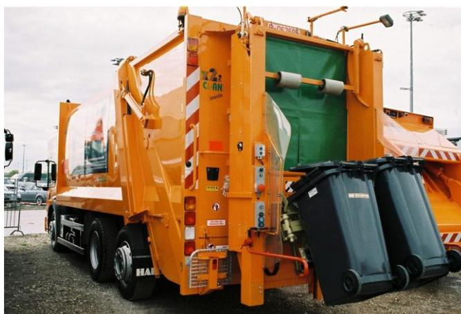
Figura 2.3. Camión de carga trasera
