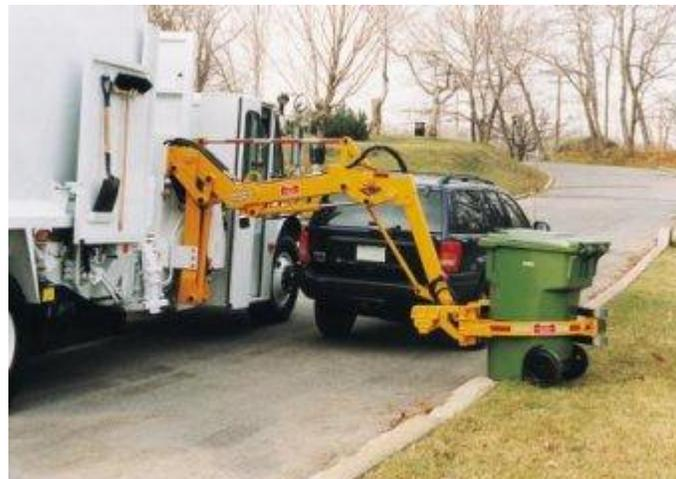
*Figura 2.4.* Camión de Carga lateral
