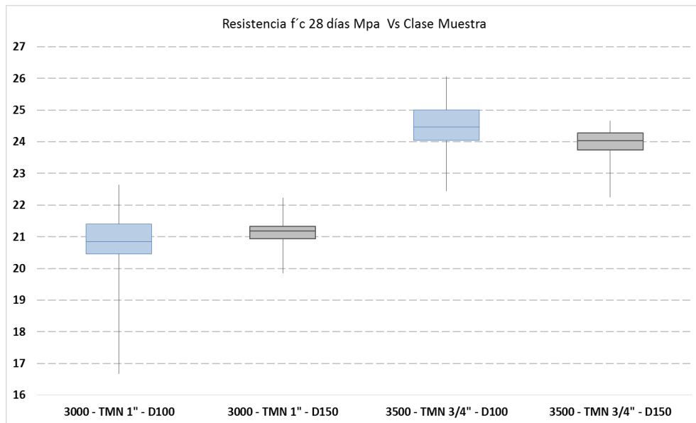
Figura 19. Gráfico de cajas y bigotes de resistencia vs clase de muestra
