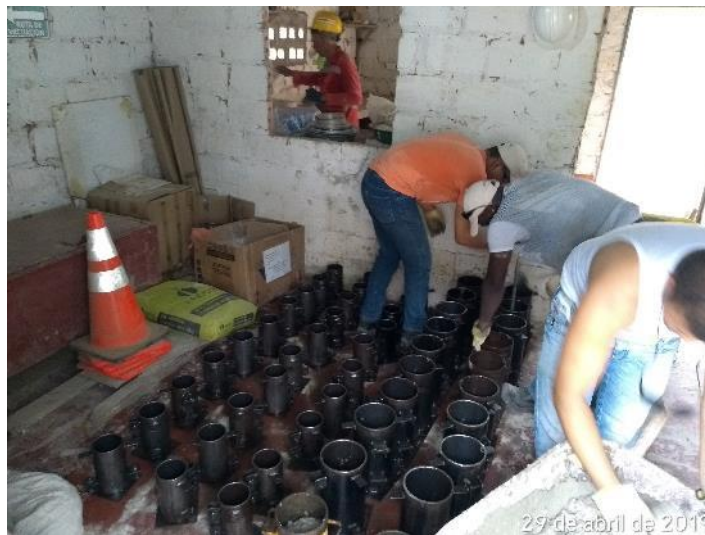
Figura 8. Moldes cilíndricos de 100 x 200 y 150 x 300 mm
