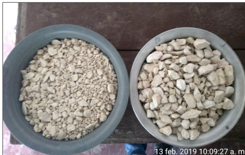
Figura 3. Grava de TMN \frac{3}{4} " y 1" utilizada para la elaboración de concreto
