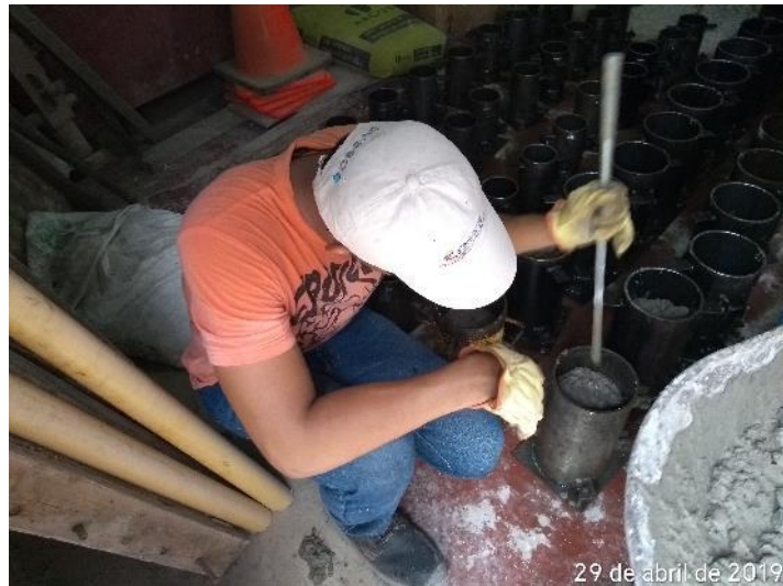
Figura 9. Compactación del concreto
