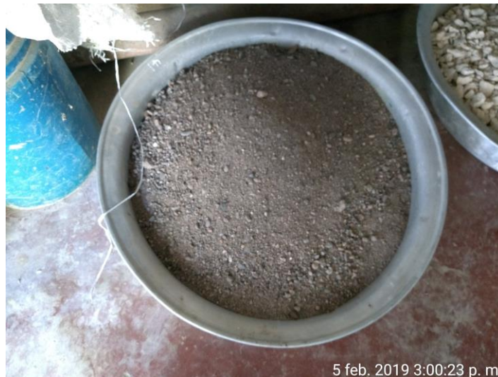
Figura 2. Arena utilizada para la elaboración de concreto
