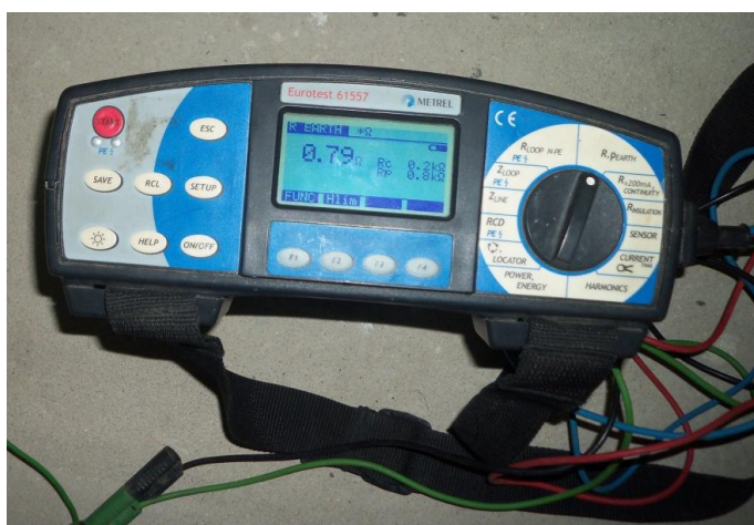
Figura 23. Medición de puesta a tierra.
