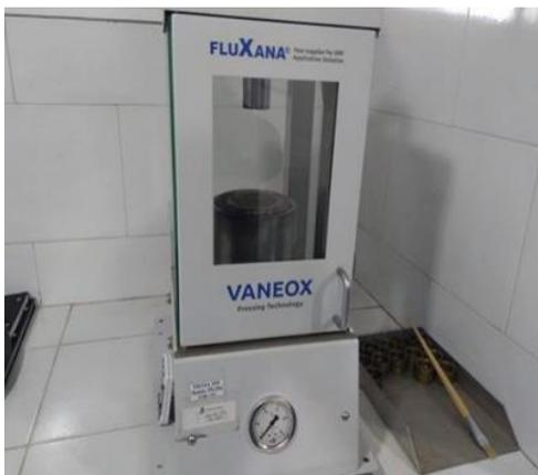
Figura 27. Equipo Empleado para FRX Fulxana Vaneox modelo PR-25m. Fuente: Elaboración de: (Bohórquez y Pacheco, 2017) Pág. 18
