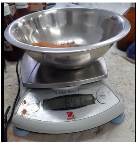
Figura 18. Muestra para Ensayo de Densidad Fuente: Porras Karla, Vizcaino Armando
