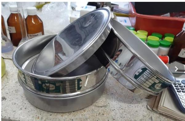
Figura 20. Tamices para Ensayo de Finura, Fuente: Porras Karla, Vizcaino Armando.
