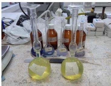
Figura 17. Frasco de Le Chatelier para Ensayo de Densidad Fuente: Porras Karla, Vizcaino Armando.
