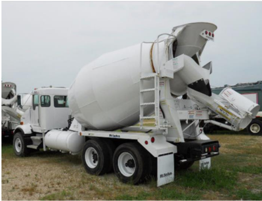
Ilustración 4 Transporte del concreto. Fuente: www.amarelasinternet.com
