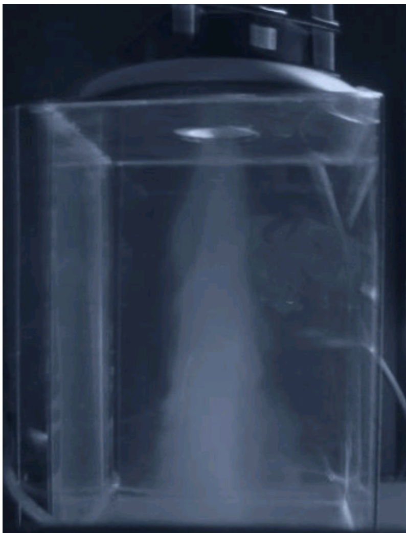
Figura 29. Simulador de tornado desarrollado en la Universidad UNAM 43
