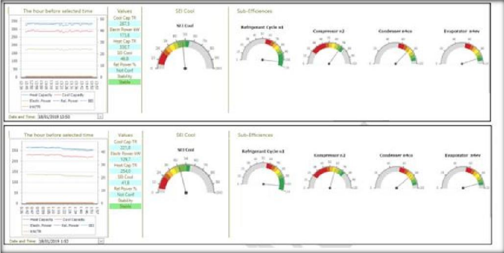
Figura 29. Eficiencias reales Chiller CHVE Clínica Porto azul al 76% de carga (arriba) y al 58% de carga (abajo). Fuente: Autor.
