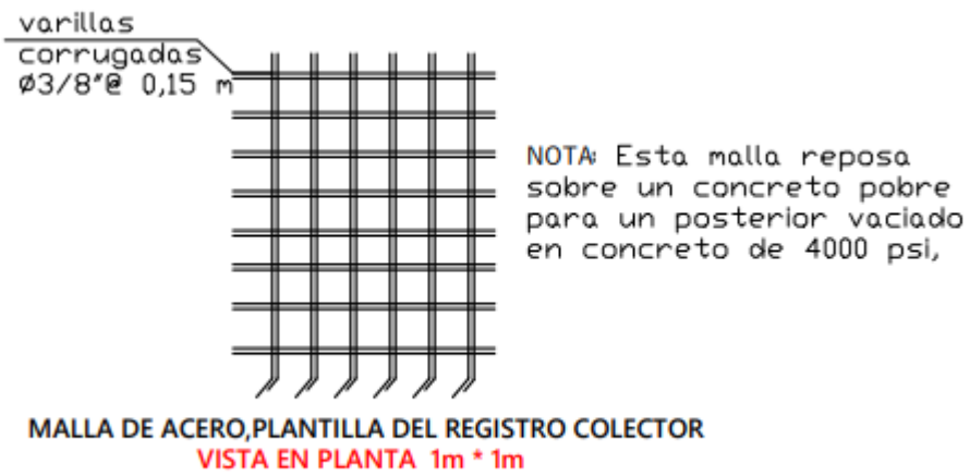
Figura 24. Acero de refuerzo para registro colector. Fuente: propia
