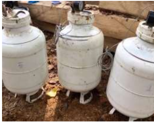
Figura 14. Reactor de biodigestión utilizado Fuente: El autor
