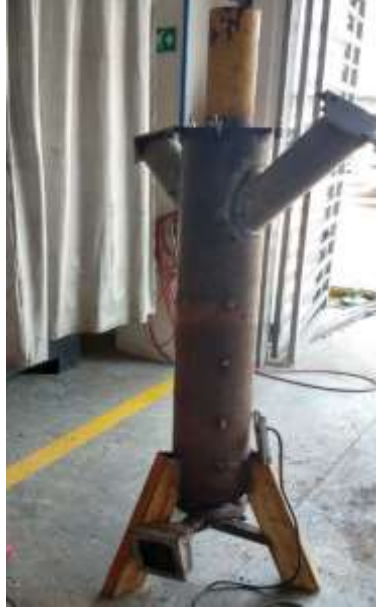
Figura 16. Microgasificador de dos zonas
