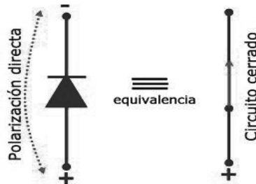
Figura No 44 48 . Funcionamiento del diodo.
