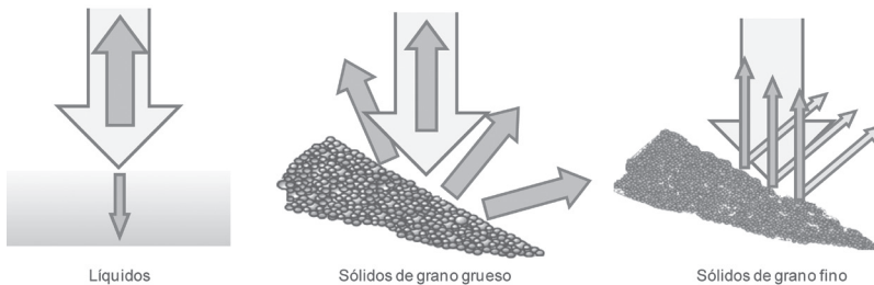
Figura 7-14. Reflexión de ultrasonido en líquidos y sólidos
