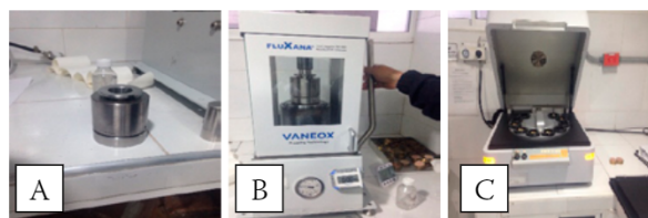
Figura 2. A: Cilindro de compactación; B: Prensa; C: Máquina FRX)
