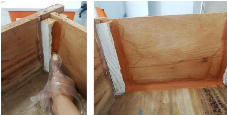
Figura 7. Sellado de bordes del canal haciendo uso de plastilina. Fuente: Elaboración propia.
