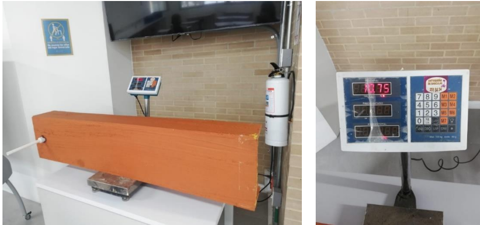
Figura 8. Masa del canal en estado seco. Fuente: Elaboración propia.
