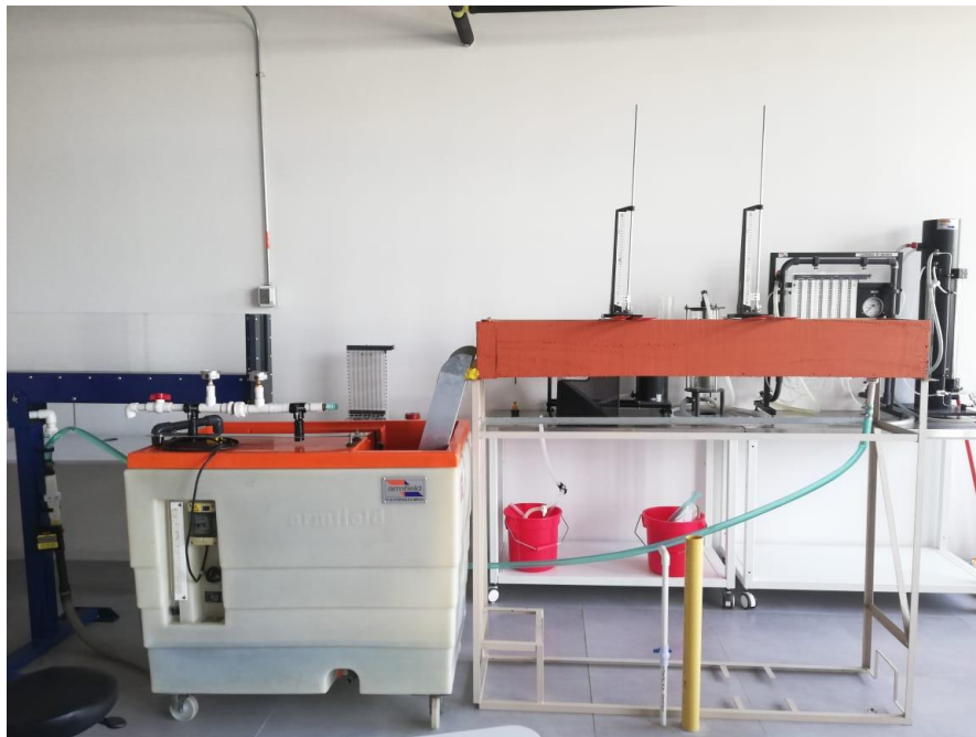
Figura 5. Montaje experimental, banco hidráulico, limnómetros, canal en madera. Fuente: Elaboración propia.
