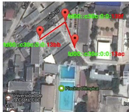
Figura 7-6 Despliegue para prueba de convergencia, con distancia de 50 m entre cada nodo.
