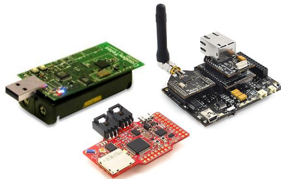
Figura 4-15 Ejemplos de nodos sensores, de izquierda a derecha TelosB Empresa Memsic , Z1 empresa Zolertia y Waspote empresa Libelium. Fuente: TelosB, (MEMESIC, 2016), Z1 (Zolertia, 2010) y Waspote (“Libelium,” 2011)
