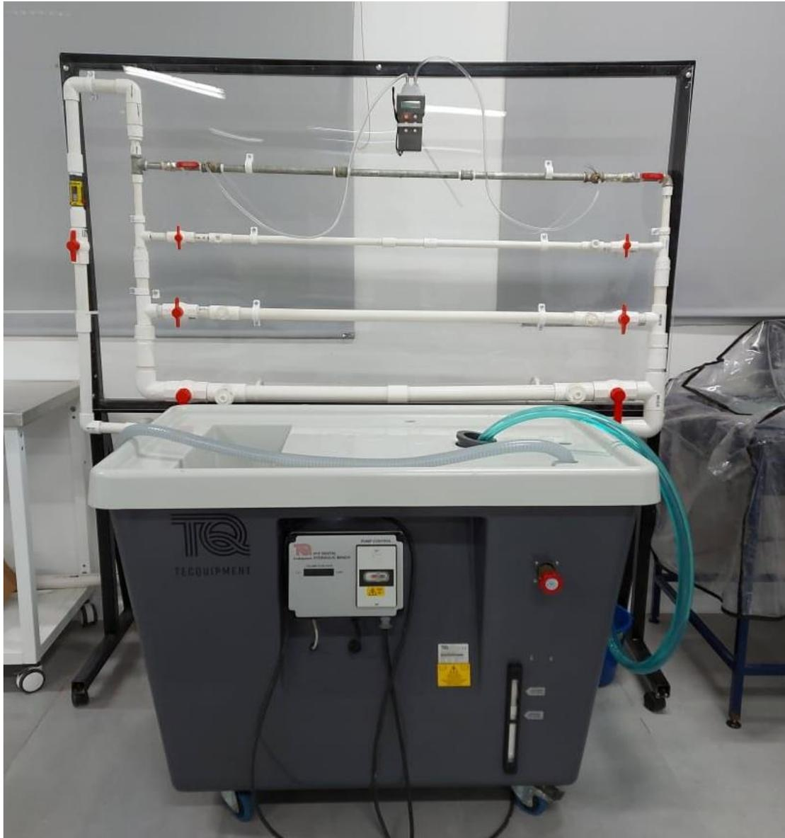
*Figura 6. Montaje de panel estable movil del sistema de tuberias diseñado. Fuente: elaboración propia.*
