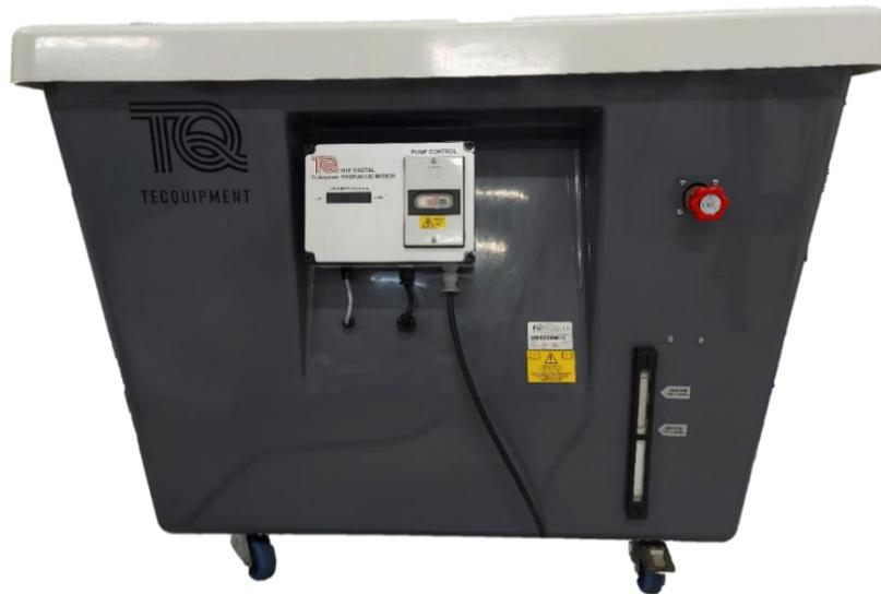
*Figura 5. Banco hidráulico H1F. Fuente: elaboración propia.*
