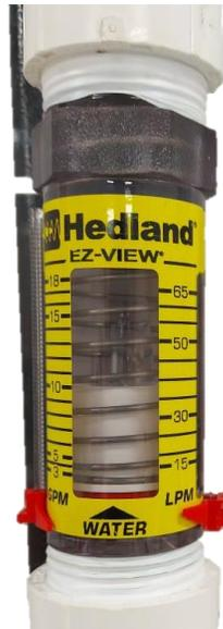
Figura 4. Caudalímetro de la serie EZ-View. Fuente: elaboración propia.
