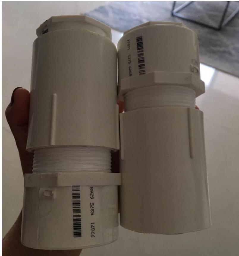
*Figura 22. Accesorios PVC utilizados para reducción de tuberías de 1-1/2" a 1"*
