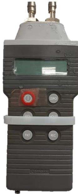
Figura 3. Manómetro diferencial digital Comark. Fuente: elaboración propia.
