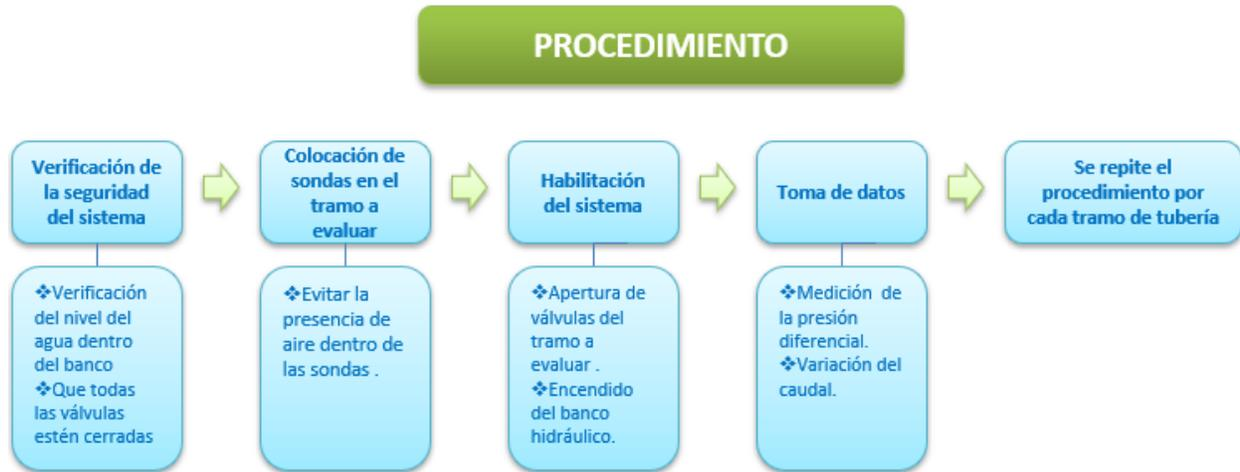
Figura 7. Procedimiento para manejo del sistema de tuberías. Fuente: elaboración propia.
