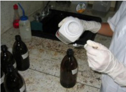
Figura 20. Adición de NaOH. Fuente: Autores.
