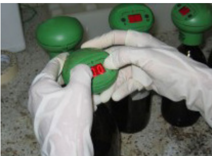
Figura 22. Encendido de cabezal oxitop DBO. Fuente: Autores.
