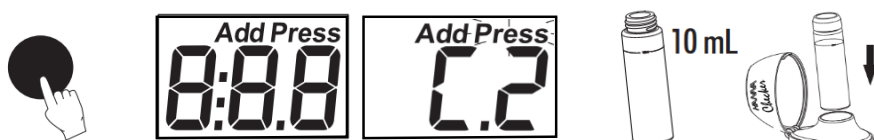
Figura 5. Paso 2: Inserción de la muestra de agua en el equipo para determinación de color aparente. Fuente: Autores.
