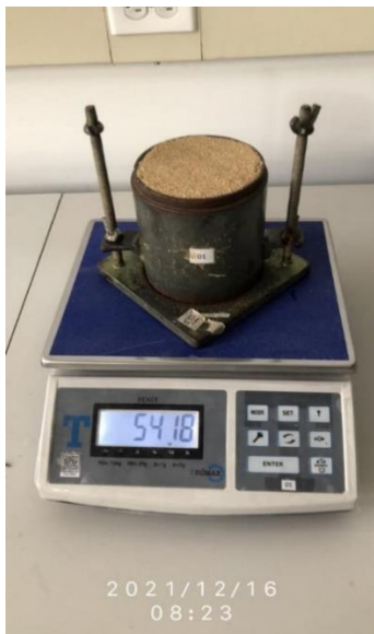
Fotografía 31. Peso del molde con material suelto (HPT). Fuente: Autores.
