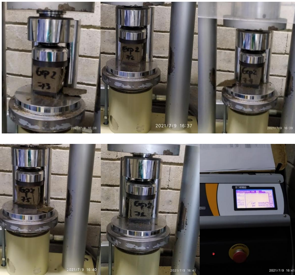
Fotografía 1. Prueba de cubos con reemplazo del 4% en las instalaciones de Ultracem S.A.S. Fuente: Autores.
