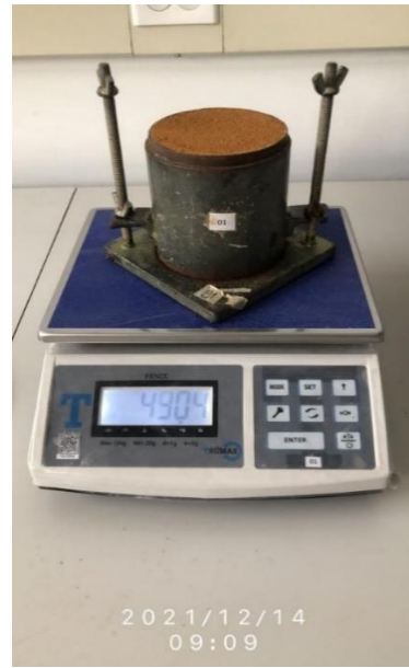
Fotografía 32. Peso del molde con material compacto (HPT). Fuente: Autores.
