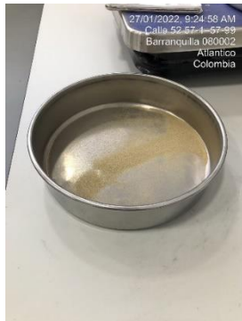
Fotografía 19. Material retenido en el tamiz # 200. Fuente: Autores.
