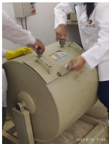
Fotografía 5. Trituración final del hueso en máquina de los ángeles. Fuente: Autores.
