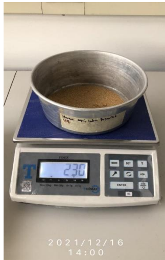
Fotografía 23. Peso de la muestra SSS (Arena). Fuente: Autores. Fotografía 24. Peso del picnómetro con agua. Fuente: Autores.
