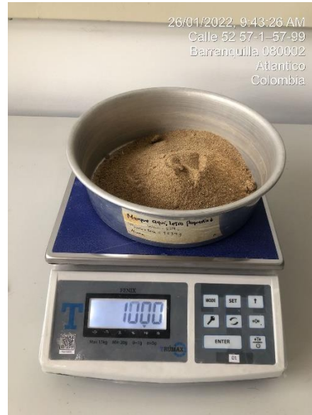
Fotografía 8. Peso material seco de la arena. Fuente: Autores.
