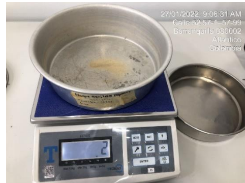
Fotografía 20. Peso del material retenido en el tamiz # 200. Fuente: Autores.
