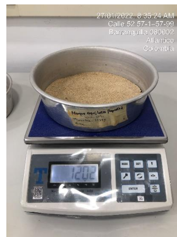
Fotografía 10. Peso del material seco con tara después de lavado. Fuente: Autores.
