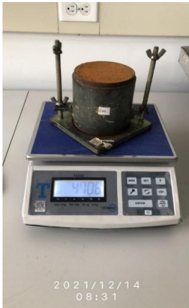
Fotografía 31. Peso del molde con material suelto (HPT). Fuente: Autores.
