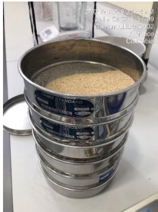
Fotografía 11. Material retenido en el tamiz # 30. Fuente: Autores.
