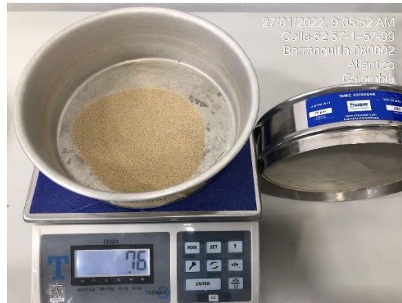
Fotografía 18. Peso del material retenido en el tamiz # 100. Fuente: Autores.
