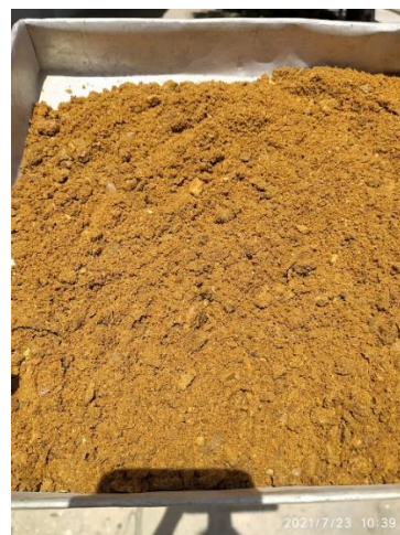
Fotografía 6. Hueso triturado en máquina de los ángeles. Fuente: Autores.
