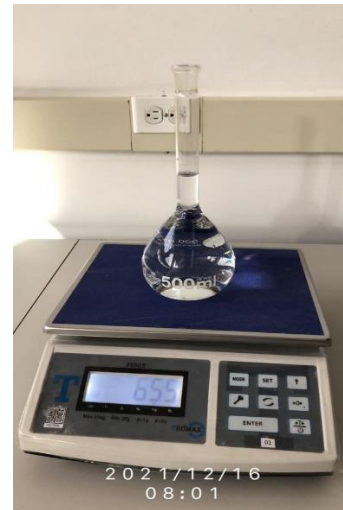
Fotografía 23. Peso de la muestra SSS (Arena). Fuente: Autores. Fotografía 24. Peso del picnómetro con agua. Fuente: Autores.
