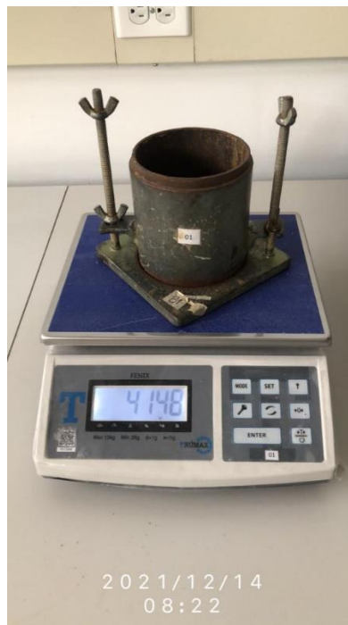
Fotografía 35. Peso del molde. Fuente: Autores.
