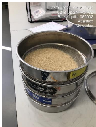
Fotografía 13. Material retenido en el tamiz # 40. Fuente: Autores.
