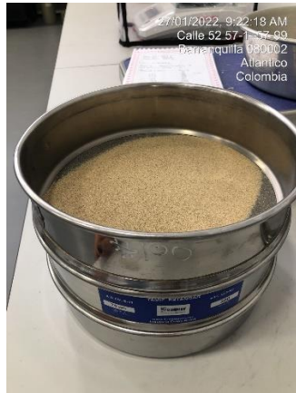
Fotografía 17. Material retenido en el tamiz # 100. Fuente: Autores.
