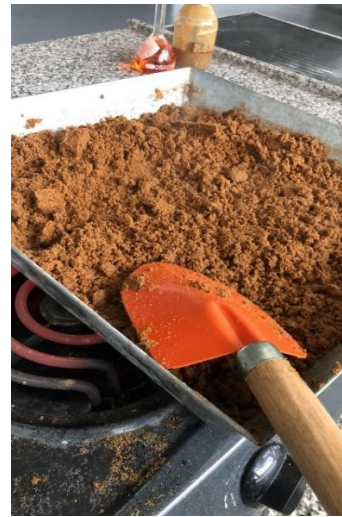
Fotografía 26. Peso de la muestra seca con tara (Arena). Fuente: Autores.
