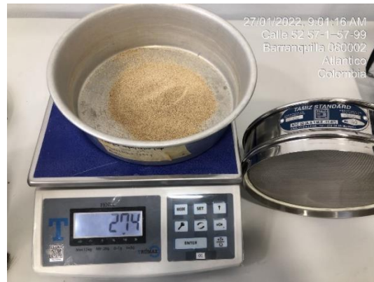
Fotografía 12. Peso del material retenido en el tamiz # 30. Fuente: Autores.
