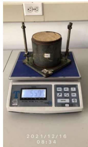
Fotografía 32. Peso del molde con material compacto (HPT). Fuente: Autores.
