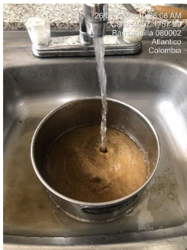
Fotografía 9. Lavado a través del tamiz # 200. Fuente: Autores.
