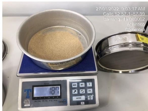
Fotografía 14. Peso del material retenido en el tamiz # 40. Fuente: Autores.
