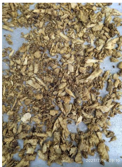
Fotografía 4. Hueso triturado seco. Fuente: Autores.
