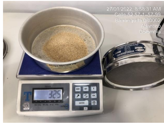
Fotografía 12. Peso del material retenido en el tamiz # 30. Fuente: Autores.
