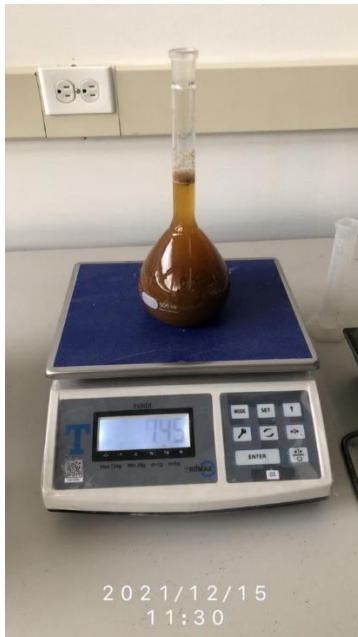
Fotografía 29. Peso del picnómetro con muestra y agua hasta marca de calibración (HPT). Fuente: Autores.
