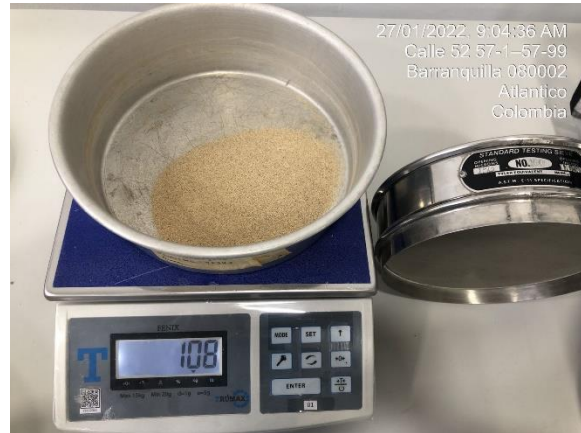
Fotografía 18. Peso del material retenido en el tamiz # 100. Fuente: Autores.
