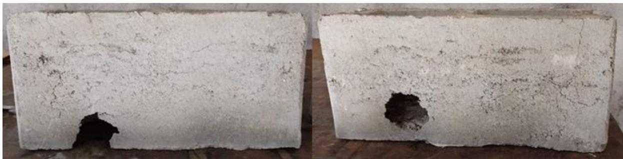
*Nota.* En la figura se observan las deformaciones (fallas y ahuecamientos) que presentó el bloque luego del fraguado. Elaboración propia, 2022.
