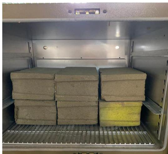
*Nota.* Las unidades fueron introducidas al horno durante 24 horas a temperatura constante de 110° C, para garantizar el secado de la muestra, que exige la norma y posteriormente pesadas para conocer su peso en estado Seco (S). Elaboración propia, 2022.
