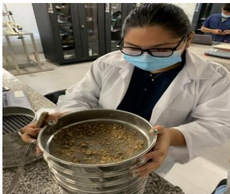
*Nota.* Proceso de tamizaje de agregados pétreos por el método de tamizado manual realizado por los tesisistas en el laboratorio de suelos de la universidad. Elaboración propia. 2021.
