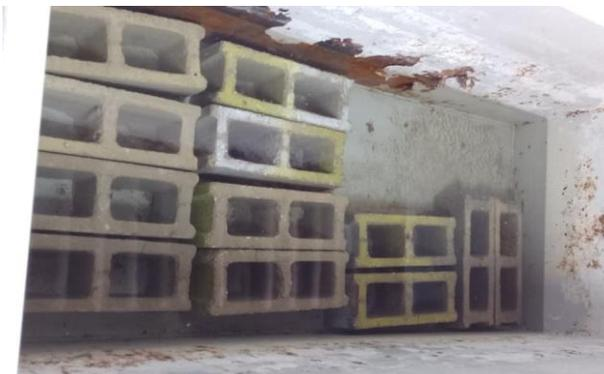
*Nota.* Las unidades fueron sumergidas durante 24 horas, para garantizar el estado de saturación que exige la norma y posteriormente pesadas para conocer su peso en estado saturado superficialmente seco (SSS). Elaboración propia, 2022.
