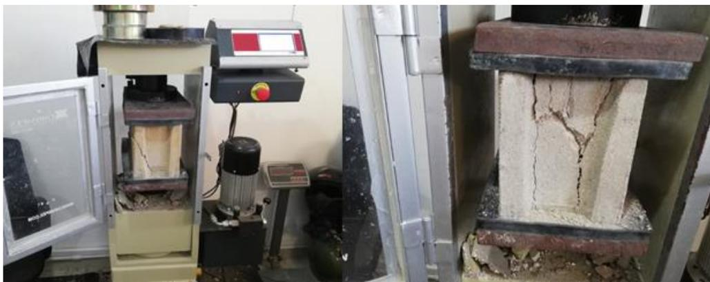
*Nota.* En la Figura 17 se muestra el instrumento utilizado para el ensayo, el cual es la máquina de compresión, además se muestra las fallas que presenta el bloque luego de alcanzar el esfuerzo ultimo. Elaboración propia, 2022.
