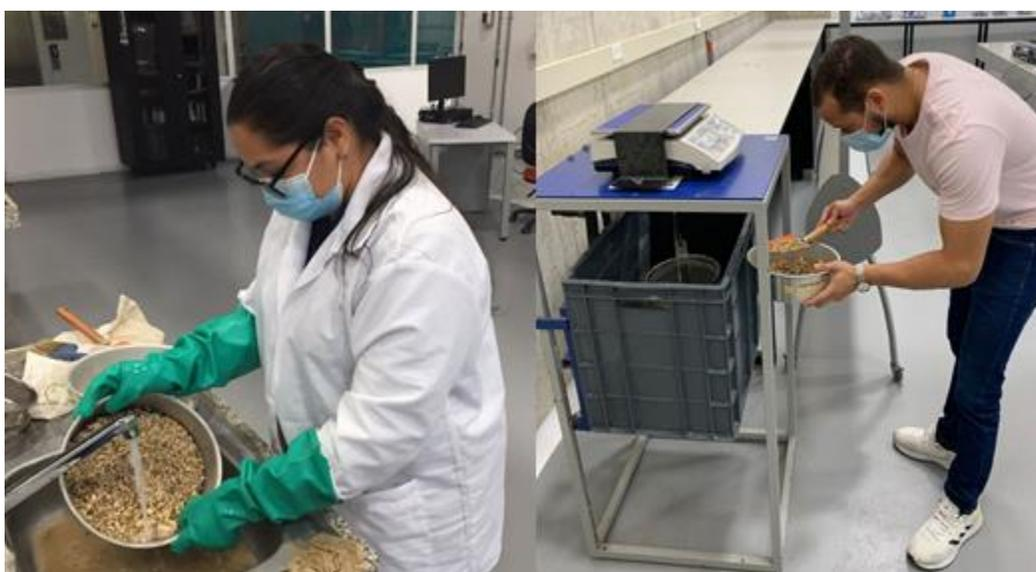
*Nota.* En la figura se observa el proceso de lavado del material y posteriormente el llenado de la canasta para sumergir el material. Elaboración propia, 2021.
