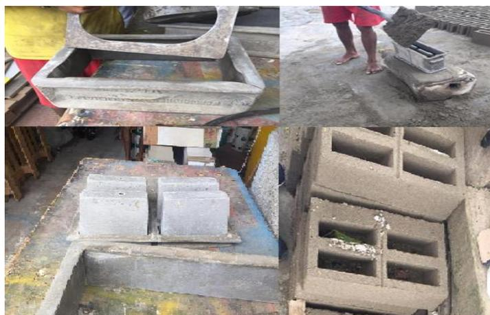
*Nota.* En la figura se observa el proceso de moldeado de los bloques fabricados en la bloquera fabricados por los tesistas. Elaboración propia. 2021.
