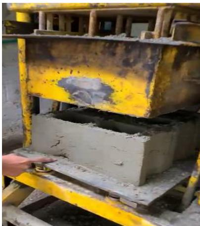
*Nota.* En la figura se observa, el agrietamiento y las deformaciones que presenta el bloque luego de ser vibrado, Según la experiencia de los obreros, eso puede ocurrir cuando la mezcla tiene mucha humedad o cuando la mezcla tiene mucho cemento. Elaboración propia, 2022.
