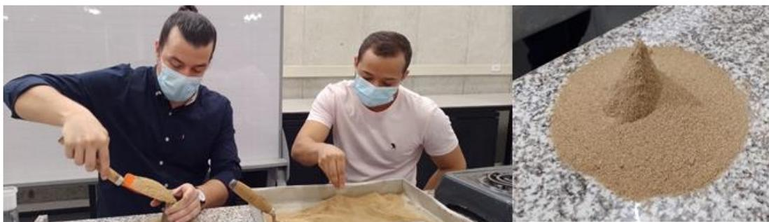
*Nota.* En la figura se observa el proceso de llenado del cono, y la comprobación del estado SSS del material fino.
