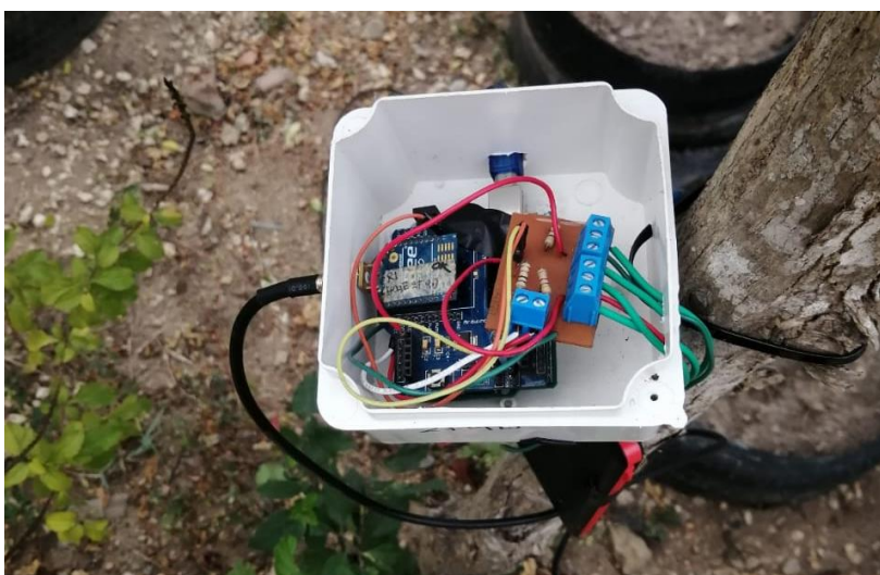
Figura 47. Mota del prototipo de red inalámbrica de sensores.
