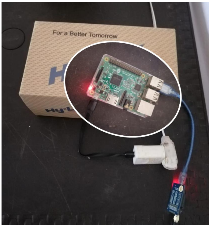
Figura 51. Nodo central del prototipo de red inalámbrica de sensores.
