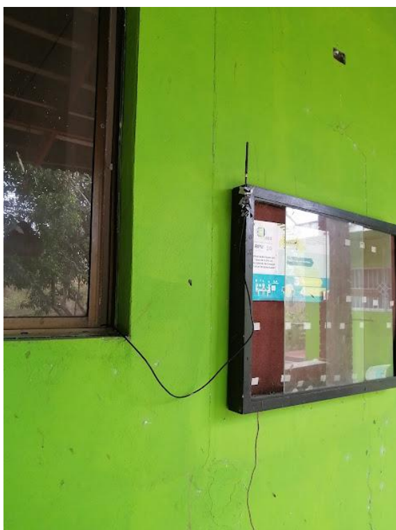
Figura 52. Antena del nodo central (0013A200409E2F93).
