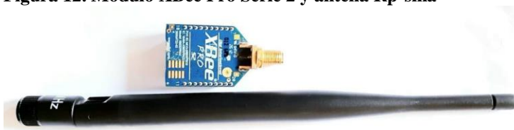
Figura 12. Módulo XBee Pro Serie 2 y antena Rp-sma
