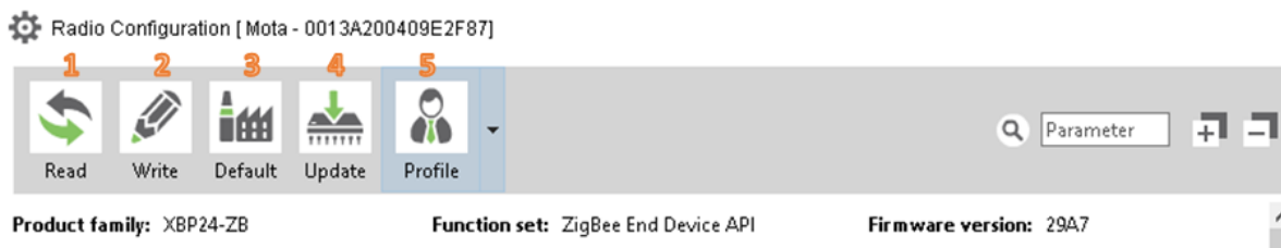
Figura 33. Herramientas de interfaz de configuración de módulo XBee.
