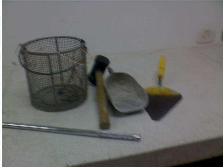
La densidad es una propiedad física de los agregados y está definida por la relación entre el peso y el volumen de una masa determinada, lo que significa que depende directamente de las características del grano de agregado.
